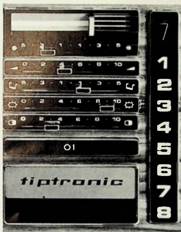
Bild 1 „Tiptronic“-Programmumschalter des Farbfernsehgeräts „Santiago Color“
